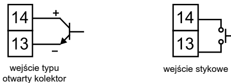
Rys. 19. Podłączenie wejścia binarnego
